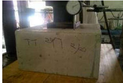
Gambar 1. Posisi pelat, dial dan *bearing* pada saat pengujian.
